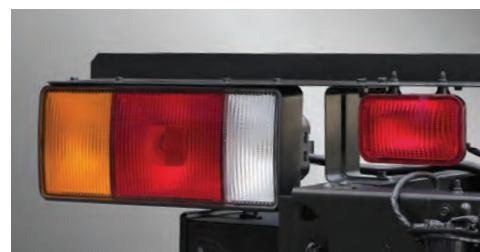
Лампы заднего комбинированного фонаря и задняя противотуманная фара
