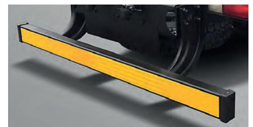
Задний противоподкатный брус
