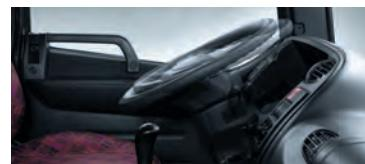
2. Рулевая колонка с регулировкой наклона и вылета
