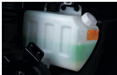
1. Расширительный бачок системы жидкостного охлаждения
